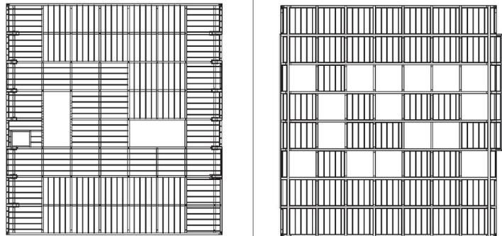
Esquemas estructurales en planta (forjados de pl. primera y cubierta)
