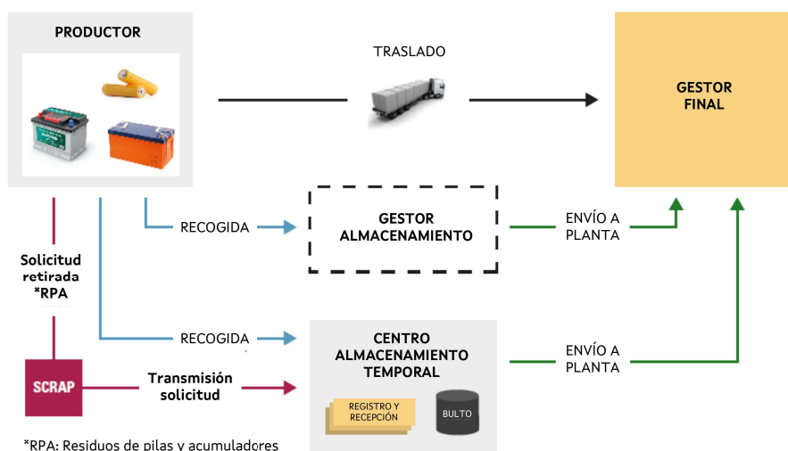
Imagen 8. Diagrama de la gestión de los residuos de pilas, acumuladores y baterías industriales y de automoción.
