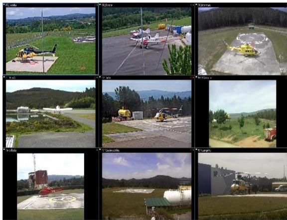
Sistema de videovigilancia en las bases de medios aéreos, con cámara web IP teledirigida y visionado en matriz configurable. Lente motorizada con autoenfoco. Sistema de transmisión inalámbrico, basado en la familia de protocolos WIMAX. Conexión a la red de datos privada de la Xunta de Galicia, con radioenlaces suscritores en oficinas provinciales, de distrito y otros emplazamientos oficiales. Grabación de vídeo bajo demanda o automatizado.
