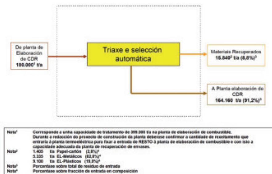
Figura 18. Balance de masa Planta de recuperación de envases de Resto 64
