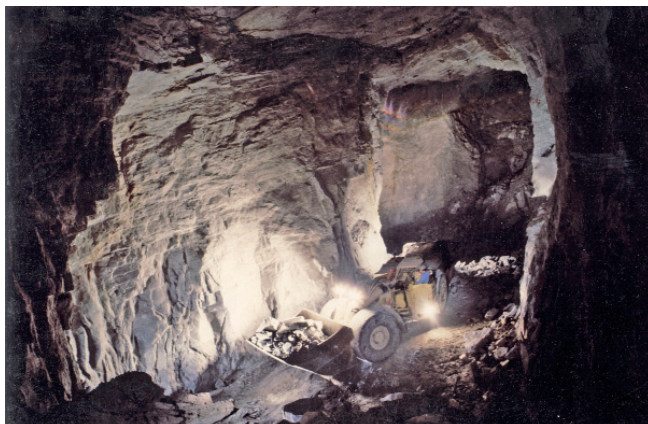
Extracción de mineral dunha cámara con pla DHL.
